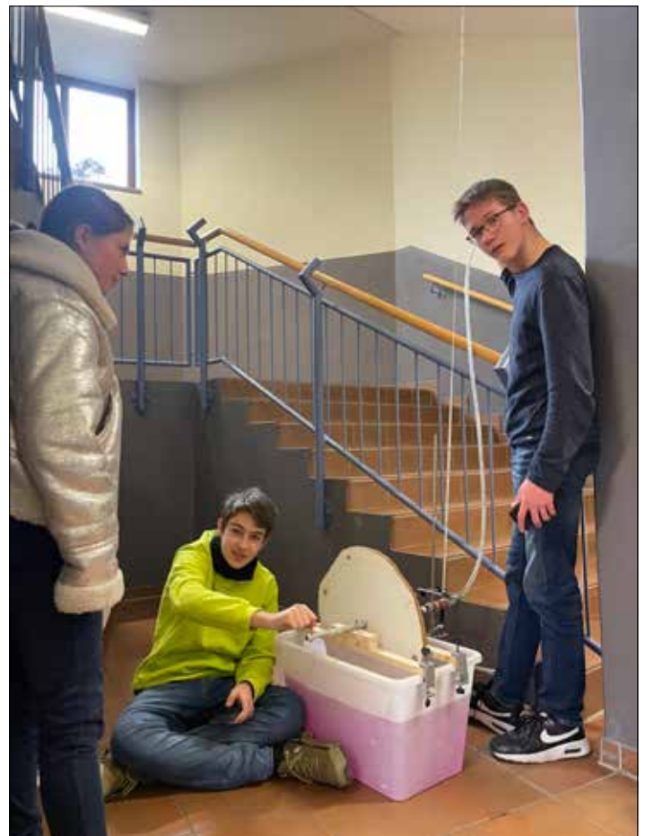
Niklas, Maresa und Theis führen Messungen mit ihrer selbstgebauten Wirtzpumpe durch.
