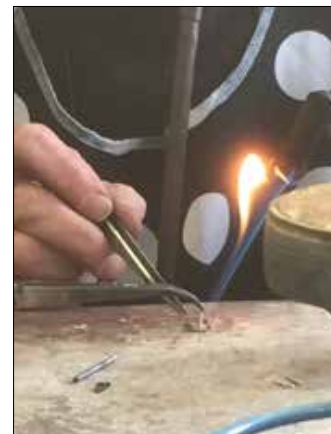
Ein Pin wird an einen Ohring angelötet.
