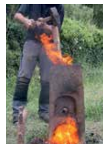
Der Rennofen wird mit Holzkohle und Eisenerz besetzt (so heißt das fachmännisch).
