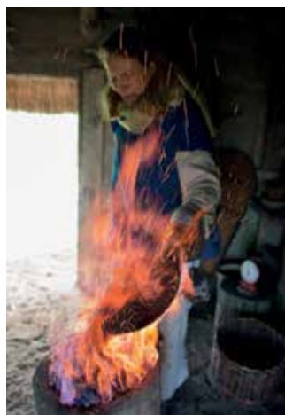
Der Rennofen wird mit Holzkohle und Eisenerz besetzt (so heißt das fachmännisch).
