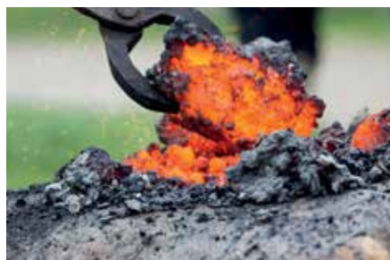
Der Rennofen wird mit Holzkohle und Eisenerz besetzt (so heißt das fachmännisch).
