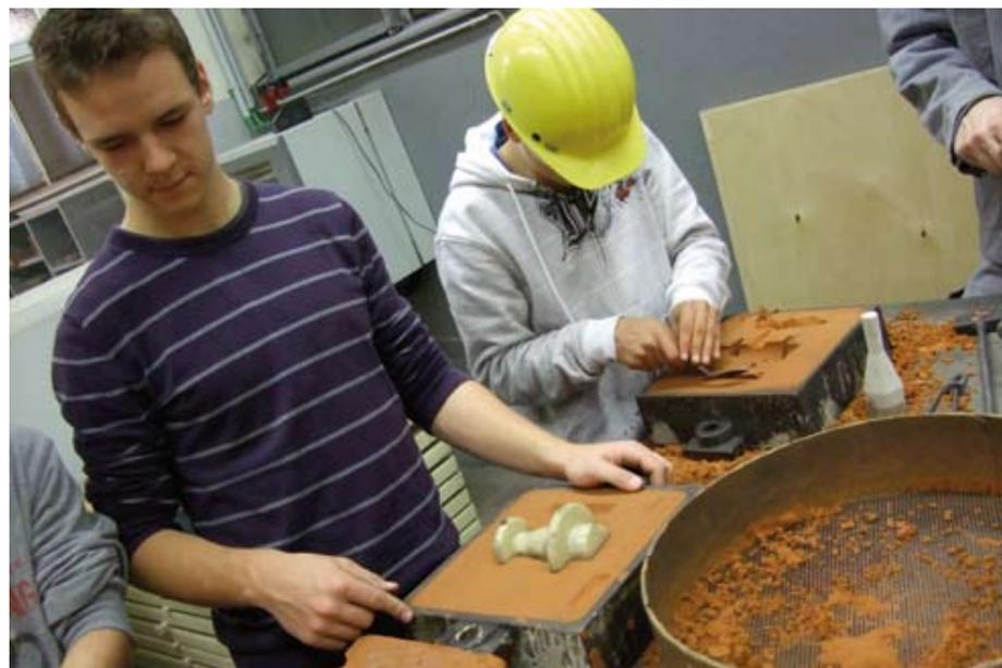
*Durch Einpressen der Positivform in den Formsand entsteht die negative Hohlform, in die anschließend das flüssige Metall gegossen wird.*
